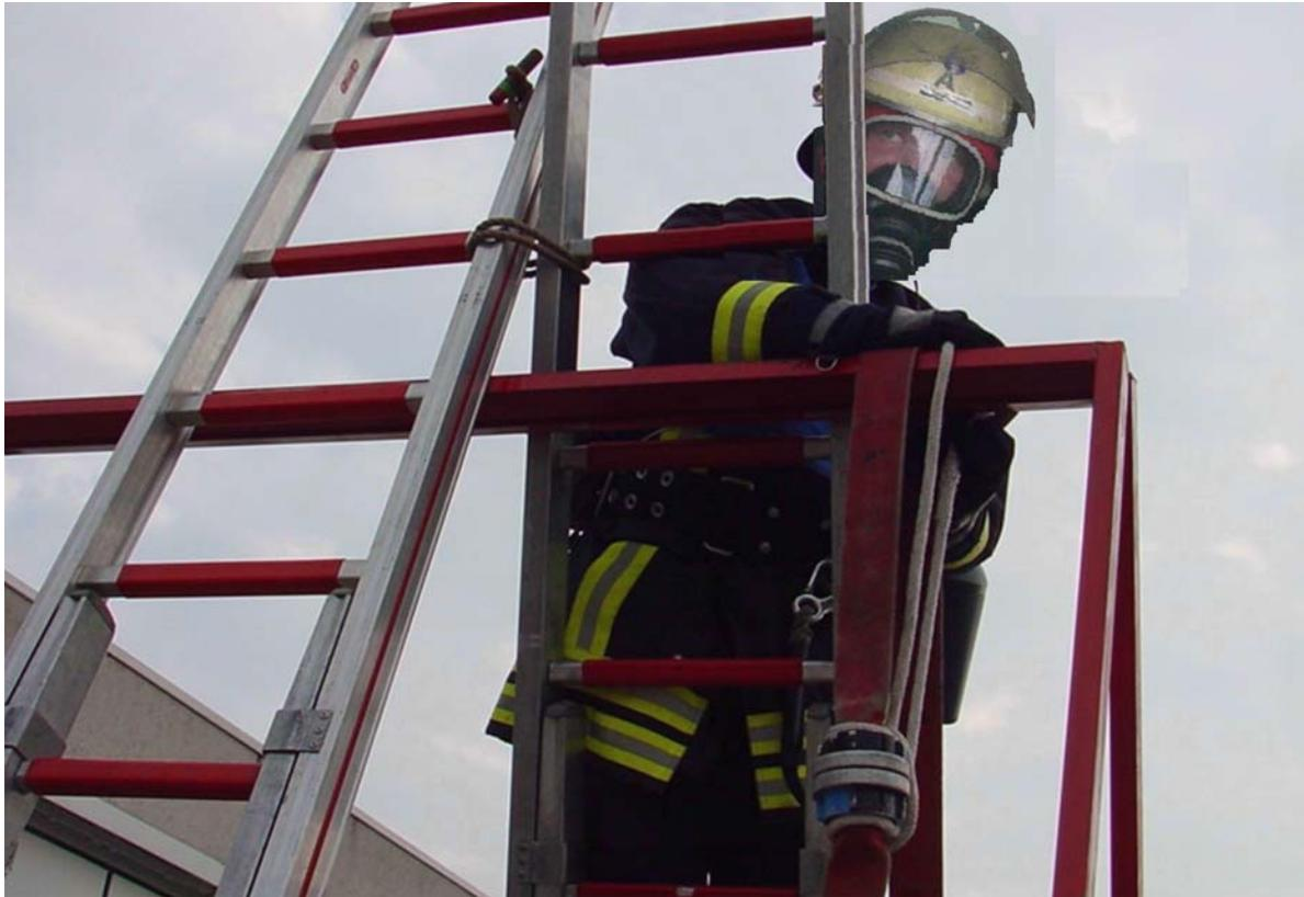
Sichern der Leiter und des Druckschlauches
